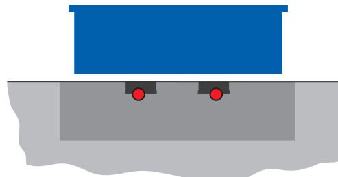
Kabel direkt im Boden verlegt
