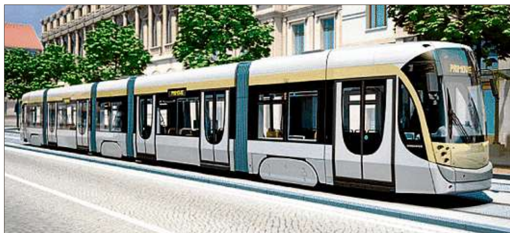
Berührungslose Mobilität: Auf der Teststrecke in Bautzen lässt die kanadische Firma Bombardier die Straßenbahn mit Vahle-Technik fahren: Mit berührungsloser Energieübertragung durch elektromagnetische Felder, die über im Boden eingelassene Leitungen erzeugt werden, fährt die Straßenbahn wie von Geisterhand. In Augsburg ist jetzt die erste Straßenbahn damit ans Netz gegangen - ein ähnliches Prinzip könnte die Zukunft der Elektroautos sein.
