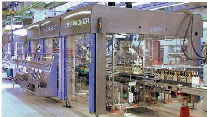
Verpackungsmaschine mit integriertem Transmodul (Bild: Vahle)
