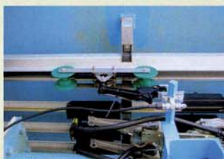
Wartungsarm: Detail des Systems für Stromversorgung und Datentransfer (Bilder: Vahle)
