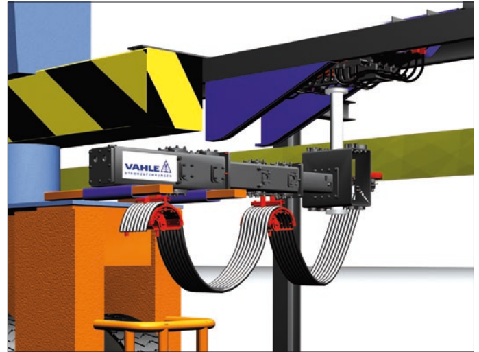
Bild 2: Beim eRTG gelangt die Stromabnehmer-Einheit via Teleskoparm über einen speziell geformten Trichter an die Stromzuführungen
