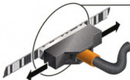
Das Positioniersystem besteht aus einem Codeband und einem Lesekopf, der die Position über die Schnittstelle an die Steuerung weitergibt.
