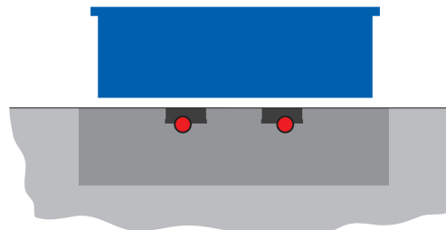
Cable tendido directamente en el suelo
